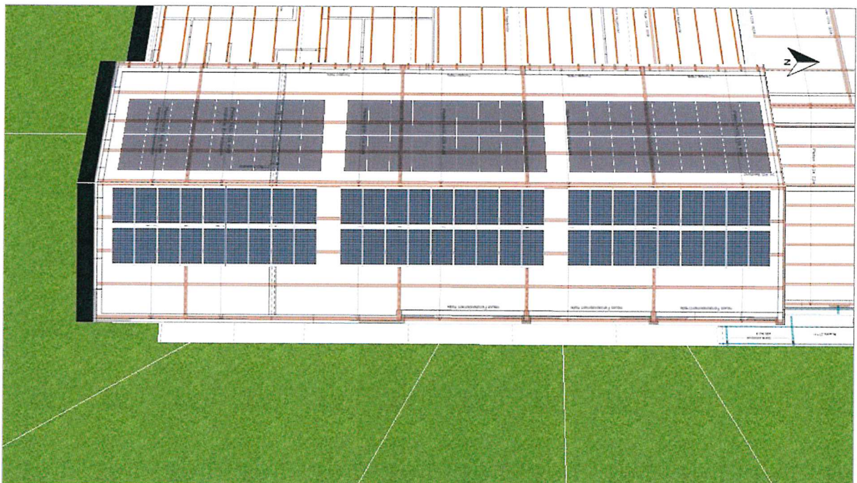
Abbildung: 1. Modulfläche - Gebäude 01-Dachfläche Ost
